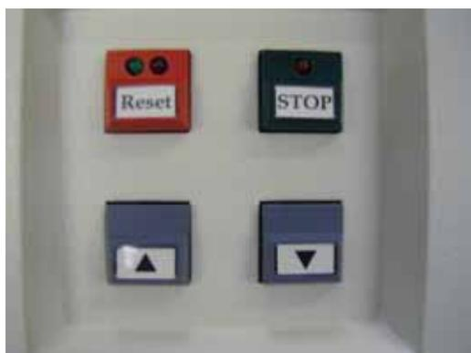
左上のスイッチは Reset スイッチです。本体内部メモリの消去時に使用します。
